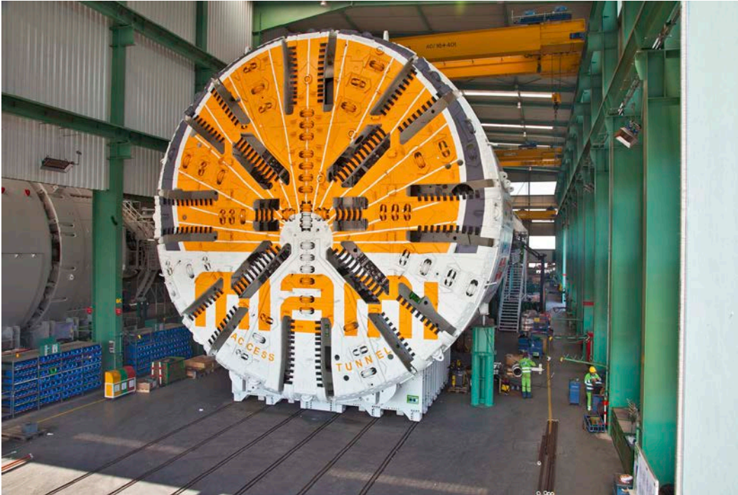
Der Herrenknecht-EPB-Schild S-600 (Ø 12.860 mm) anlässlich der Abnahme im Schwanauer Werk im April 2011.
