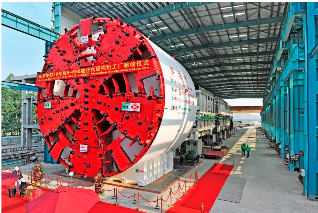
Bild 1: Der Herrenknecht Mixshield S-668 ( \varnothing 11.610 mm) anlässlich der Werksabnahme in Nansha, Guangzhou, China.
